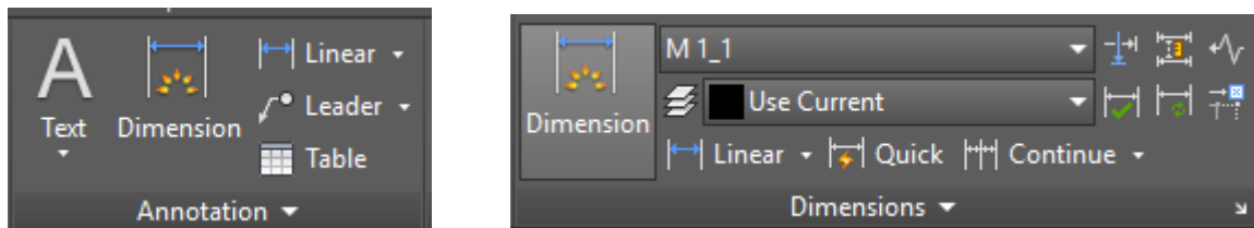
Slika 7.151 Paneli s altima za kotiranje
