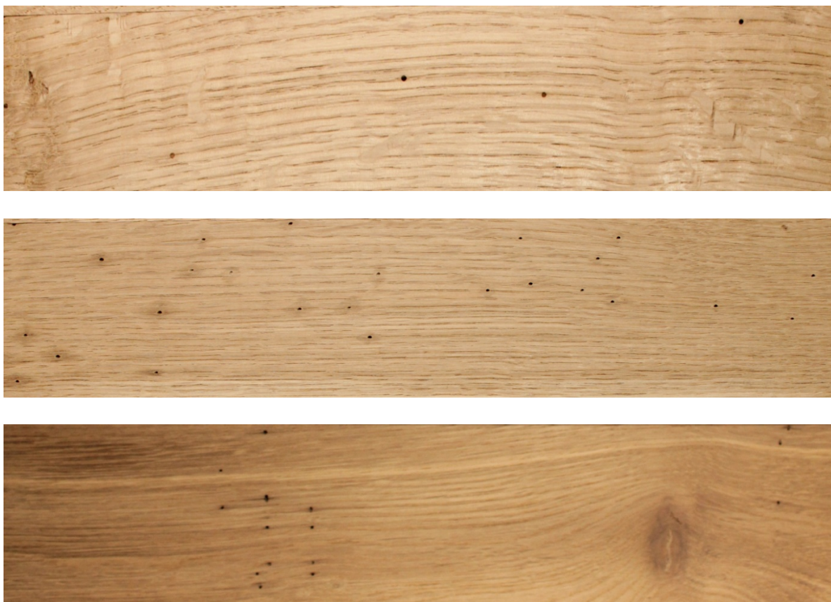
Slika 39. Izletni otvori ksilofagnih insekata
