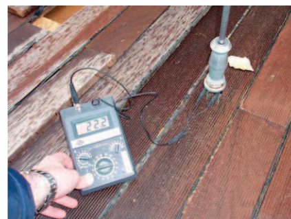
Slika 8: Na vrtnoj terasi sadržaj vode i na površini je dasaka visok, naročito na zamočenim dijelovima, što uzrokuje ekscesno bubrenje, sabijanje kita, vitoperenje i izdizanje dasaka (lijevo)
