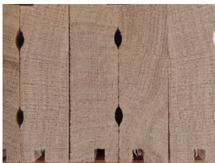
Slika 10. Uzorci izuzeti iz originalnih pakiranja parketa sa zgrade. Nakon apsolutnog sušenja na 103 °C prepiljeni parketi nigdje ne iskazuju poprečne čelne pukotine (lijevo-radijalna tekstura tj. blistače, sredina tangenta tekstura tj. bočnice, desno poluradijalna tekstura).
