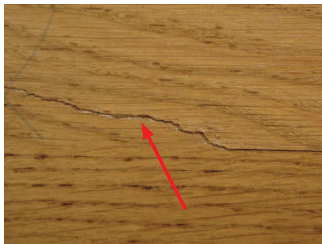
Slika 5. Hodnik: tragovi laka pod pukotinom od razlistavanja. Tangentna tekstura (bočnice)
