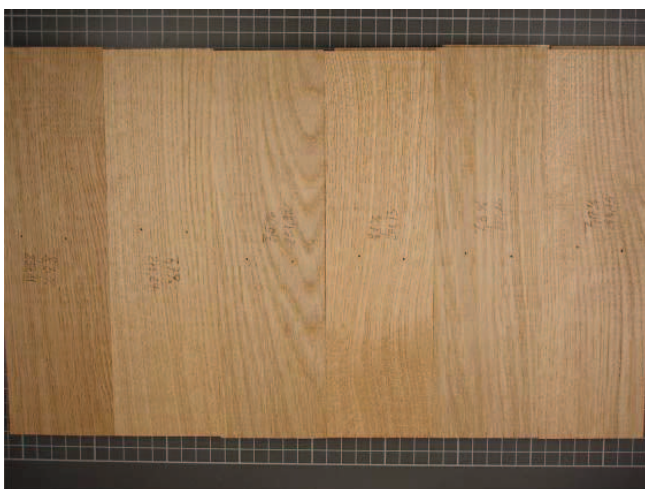
Slika 9 a ) lijevo - blistače i b) desno - bočnice. Parket izuzet sa zgrade, nakon apsolutnog isušivanja na 103 °C, ne pokazuje razlistavanje, niti kakve proširene površinske pukotine.
