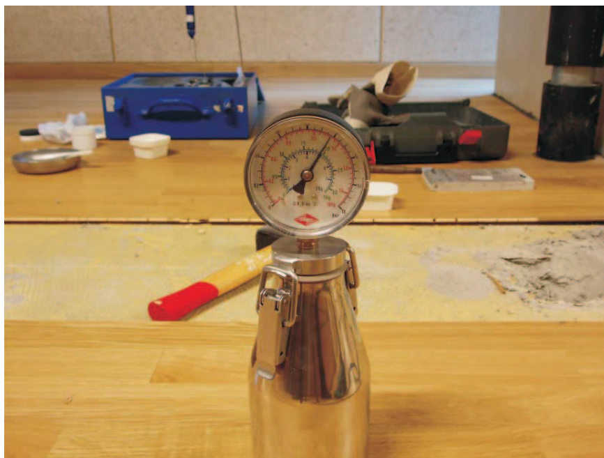
Slika 6. Sadržaj vode cementne podloge, mjeren CM uređajem, na gornjoj je graničnoj vrijednosti od 2% (zeleni skala)
