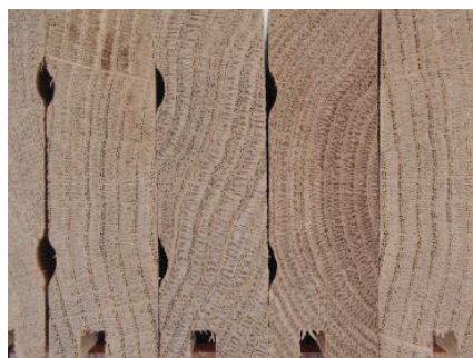
Slika 10. Uzorci izuzeti iz originalnih pakiranja parketa sa zgrade. Nakon apsolutnog sušenja na 103 °C prepiljeni parketi nigdje ne iskazuju poprečne čelne pukotine (lijevo-radijalna tekstura tj. blistače, sredina tangenta tekstura tj. bočnice, desno poluradijalna tekstura).
