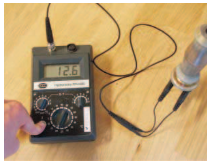
Slika 5. Sadržaj vode mjereno električnim vlagomjerom na istom mjestu uboda: lijevo – na površini daske (u dubini do 4mm); desno – pri dnu daske (na dubini od 13mm)
