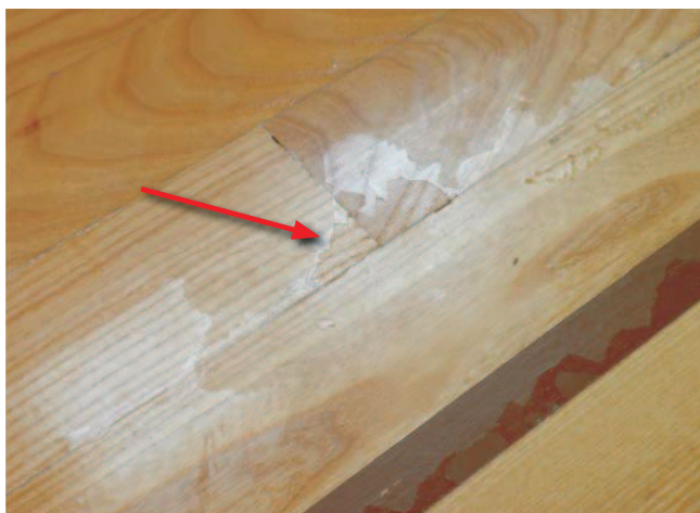
Slika 3. Greške ljuštenja laka u različitim oblicima. Lijevo i na smeđoj liniji vidi se odvajanje samo najgornjeg sloja debljine cca 90µm, a u sredini se odvaja kompletan film od impregniranog drva (streljica)
