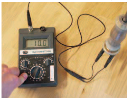
Slika 5. Sadržaj vode mjereno električnim vlagomjerom na istom mjestu uboda: lijevo – na površini daske (u dubini do 4mm); desno – pri dnu daske (na dubini od 13mm)
