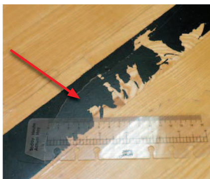
Slika 4. Odvajanje pokravnog laka s linije (streljica) kao i odvajanje linije od podložnog sloja laka
