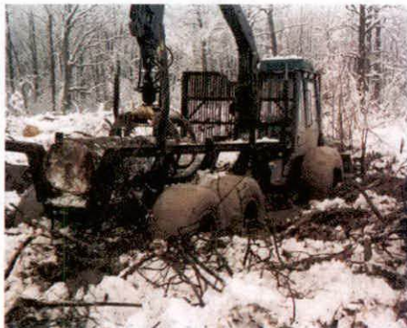
Figure 13. Limited soil strength Slika 13. Tlo ograničene nosivosti
