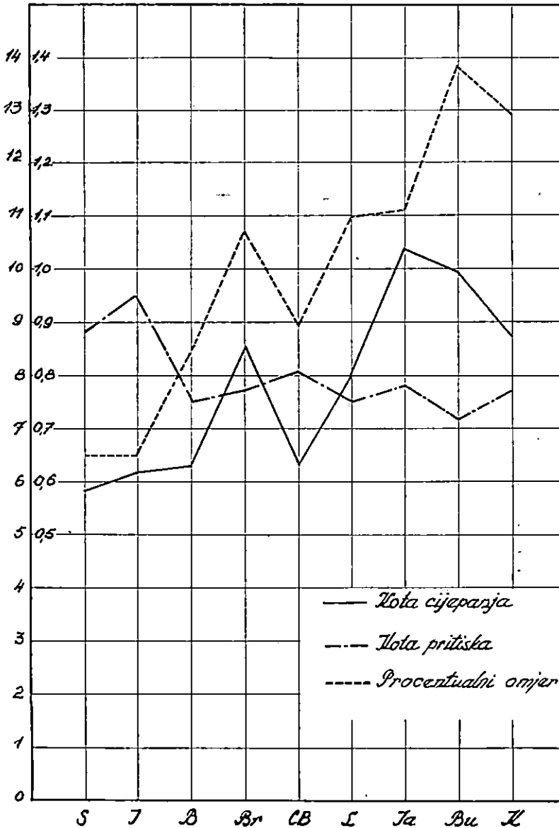
Sl. 16. Grafički prikaz kvalitetnog broja radijalne čvrstoće cijepanja, čvrstoće pritiska i procentualnog omjera za sve istražene vrste drveta.
