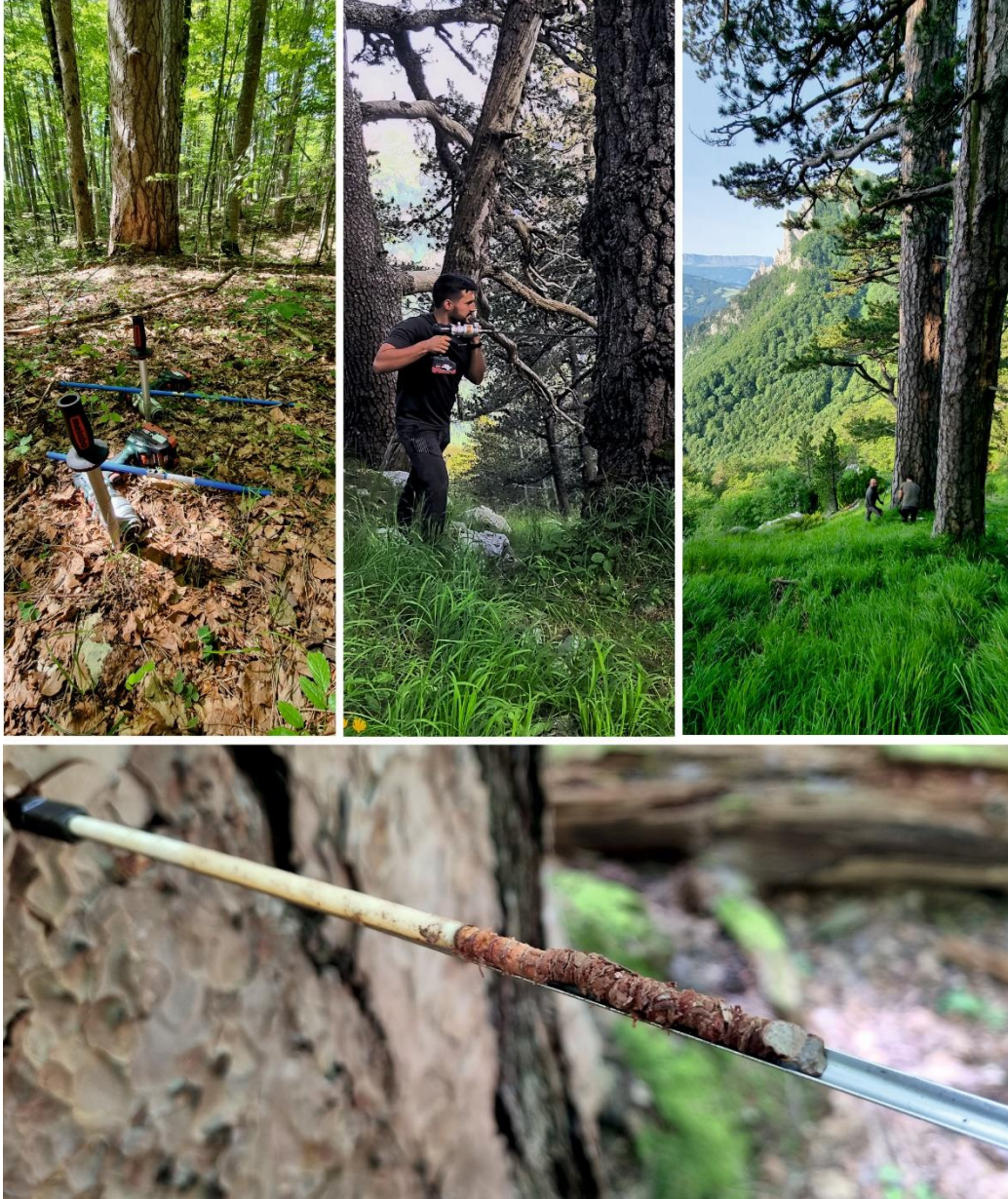
Slika 12. Prikupljanje uzoraka pomoću električne bušilice sa stabala munike i crnoga bora
